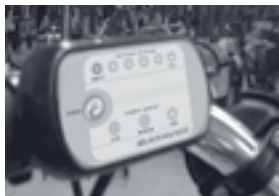
Betjeningsdisplay på styret Lamperne foroven angiver batteriets kapacitet.
